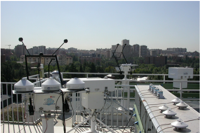
Figura 2.5.: Los piranómetros y pirheliómetros son calibrados periódicamente frente a sensores patrón.
